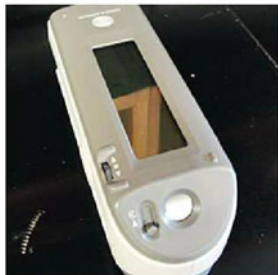
Spektrofotometr, přístroj zjišťující množství skvrn, které je pasta schopna odstranit.
